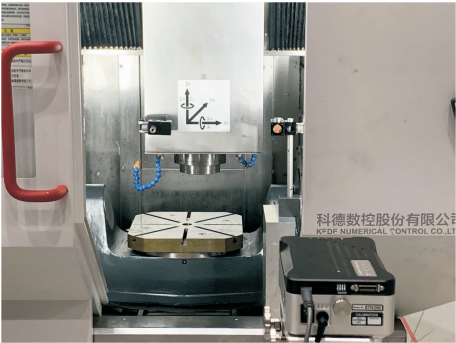
图 9 激光干涉仪测量三个直线轴几何误差
